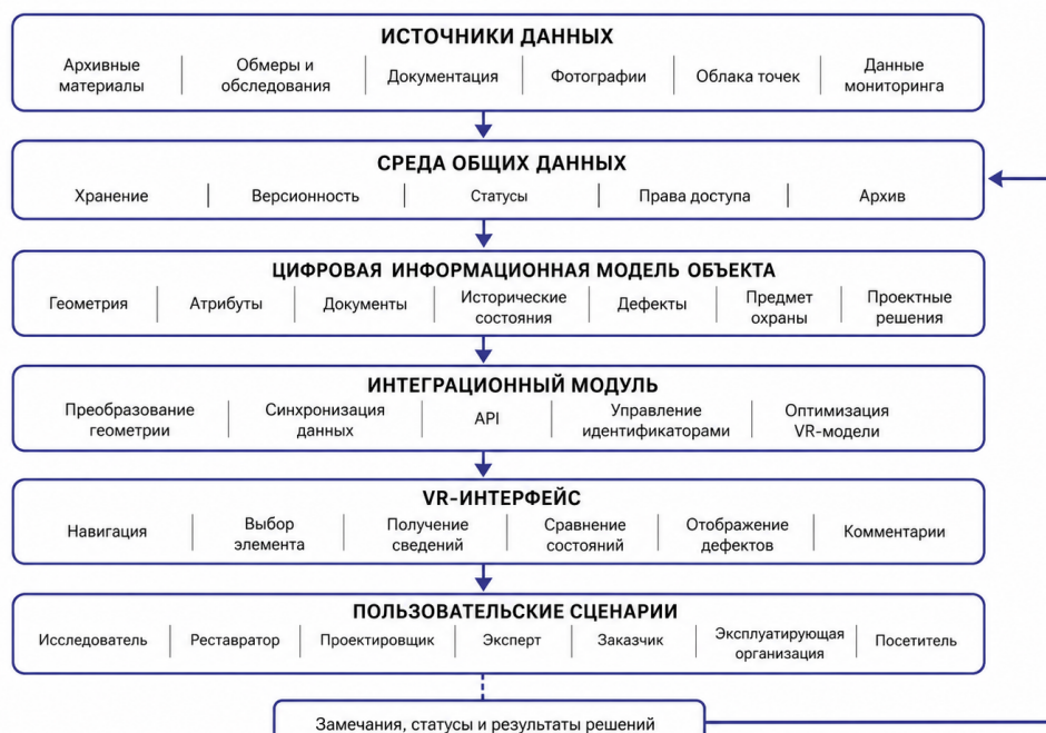
Рисунок 1. Архитектура информационного взаимодействия между средой общих данных, HBIM-моделью и VR-интерфейсом (разработано авторами)
